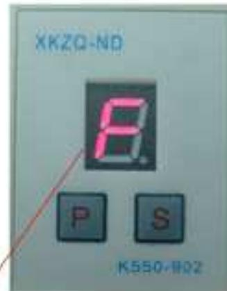
**F** é para ajuste da interface pelo técnico. Onde se consegue aumentar, diminuir e bloquear a velocidade máxima de ajusteno **P**
