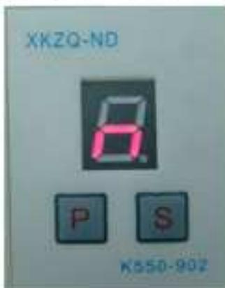
Pela tecla P, entre na configuração do "n", que é para o Ajuste para início.
