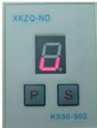
Para a operadora ajustar a velocidade dentro da interface, deverá acionar a tecla **P** e aparecerá a letra **U**, conforme a luz acima.
