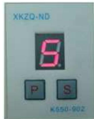
Apertando a tecla **S**, você pode ajustar o torque (Arranque) do motor de 0~9. Aperte **P** para confirmar. O máximo no sistema é de 5, se ajustado muito alto, resultará no desempenho e uso.
